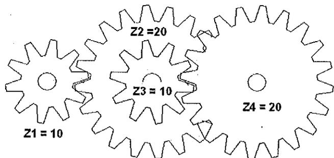
*En el siguiente tren de engranajes Z1 está unido al eje motor.*
